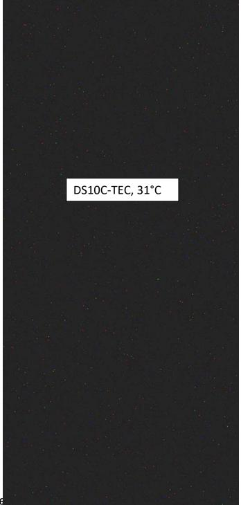
30 x 20sec, min gain, TEC on -5, white point 15 ASI294, -5°C DS10C-TEC, -5°C
